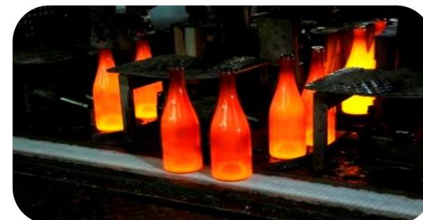
Le calcin est mis en fusion afin d'être coulé et modelé par soufflage pour donner vie à de nouveaux objets en verre.
